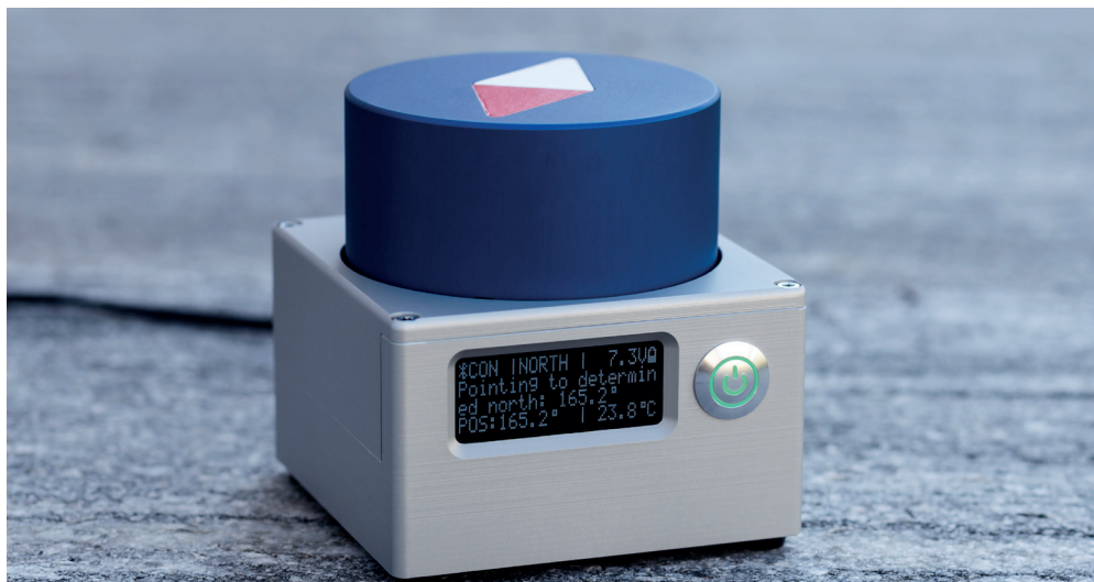
Präzisions-MEMS-Gyroskops zur Bestimmung der Himmelsrichtung.
